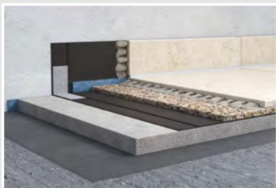
BALTERRA EP DRAIN – Keramikverlegung auf einer Dünnbettdrainage
